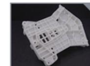
ナイロン12（=ポリアミド12、PA12）は機械部品等によく使用される結晶性の熱可塑性樹脂です。強度・靱性・耐摩耗性に優れ、柔軟性もあるので形状の工夫によりバネ機構などにも応用できます。
