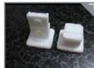
ナイロン12と同じ結晶性のポリアミドです。ナイロン12に比べ、柔軟性が高いのが特徴です。ヒンジ形状など、大きな変形が必要な部品により適しています。
