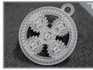
光硬化性のアクリル樹脂です。若干の変形は可能ですが、曲げにはあまり強くなく欠けやすいです。紫外線による変色や湿気・熱による劣化が起るため、長期的に使用する部品には使用できません。
